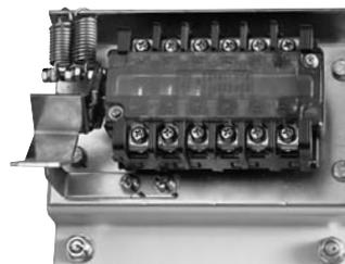
Механически управляемый коммутатор
